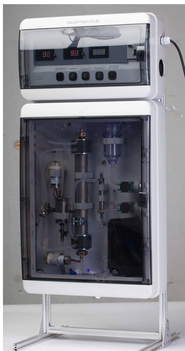
Установки СТЭЛ-АНК-СУПЕР-100 (производительность по Анолиту АНК СУПЕР 100 л/ч). Два фото слева — модель 2019 года. Справа - модель 2021 г., которая, помимо Анолита АНК СУПЕР, способна синтезировать раствор ХЧ хлорноватистой кислоты производительностью до 20 л/ч при концентрации 500 - 600 мг/л. Россия. Новая Зеландия 2021
